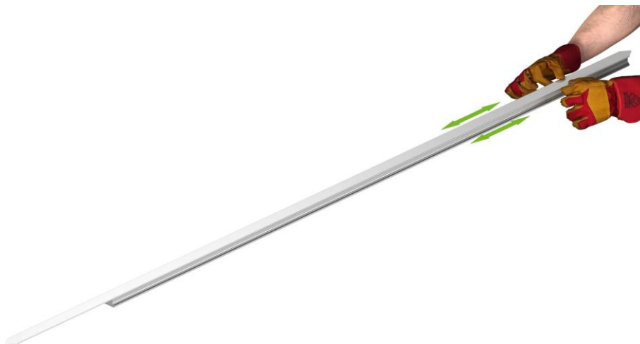
Rys. 5.28: Zaciskanie taśmy osłonowej na długości ok. 3 cm
